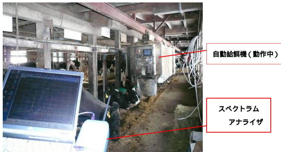
図3-3-1 スペクトラムアナライザで測定した現場調査
