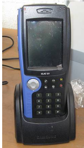
図 3-3 ハンディターミナル/クレードル設置状況
