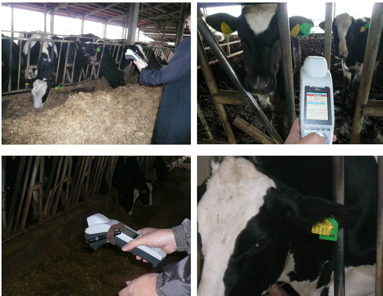
図 2 - 4 - 3 ハンディターミナル読取り試験の状況 (B 牧場) 上：ハンディ読取り試験 (前方) 下：レーザポインタを使用してハンディの方向確認
