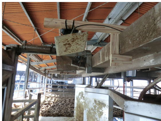
図 2 - 2 - 4 アンテナの取付状況（進行方向逆側） 図左：右側レーンの写真 図右：左側レーンの写真
