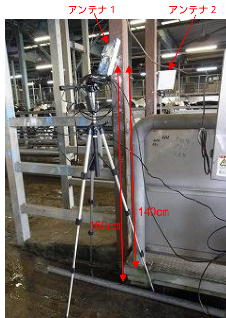
図 39 アンテナ設置状況(仙台市のFと畜場)
