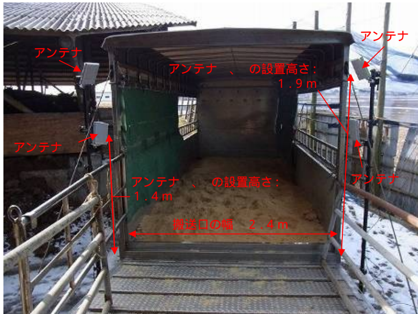
図 36 牛の搬送口(搬送車の積み込み口)と設置リーダのアンテナ配置
