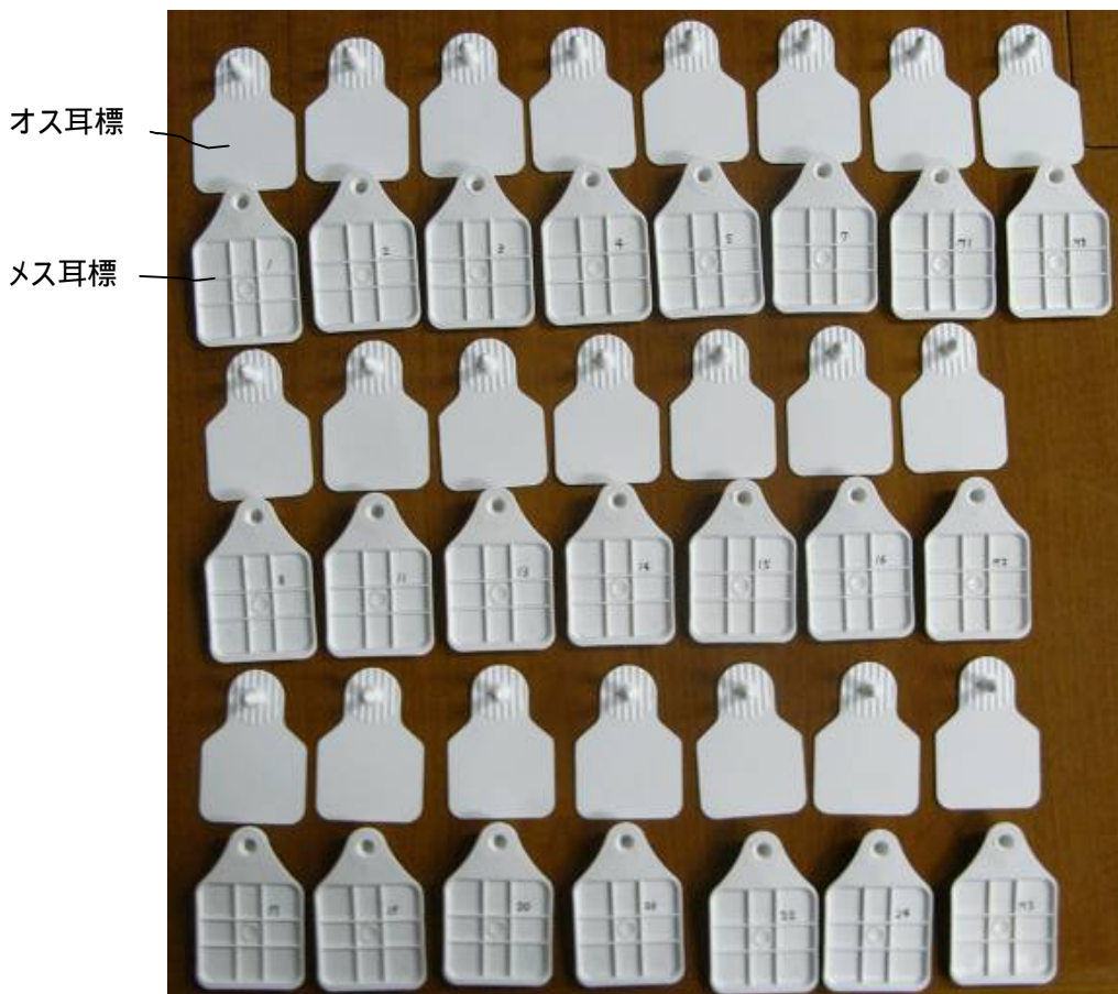
【写真25】「写真24」のインレイを射出成形によりメス耳標に樹脂で封止
